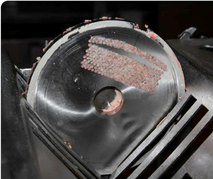
Abb. 1: Trennschnittsatz eines Fleischwolfes mit einer Kombination aus Trenn-, Schneid- und Ausformsatz (oben), sowie Eyeshape-Formscheiben (unten)
